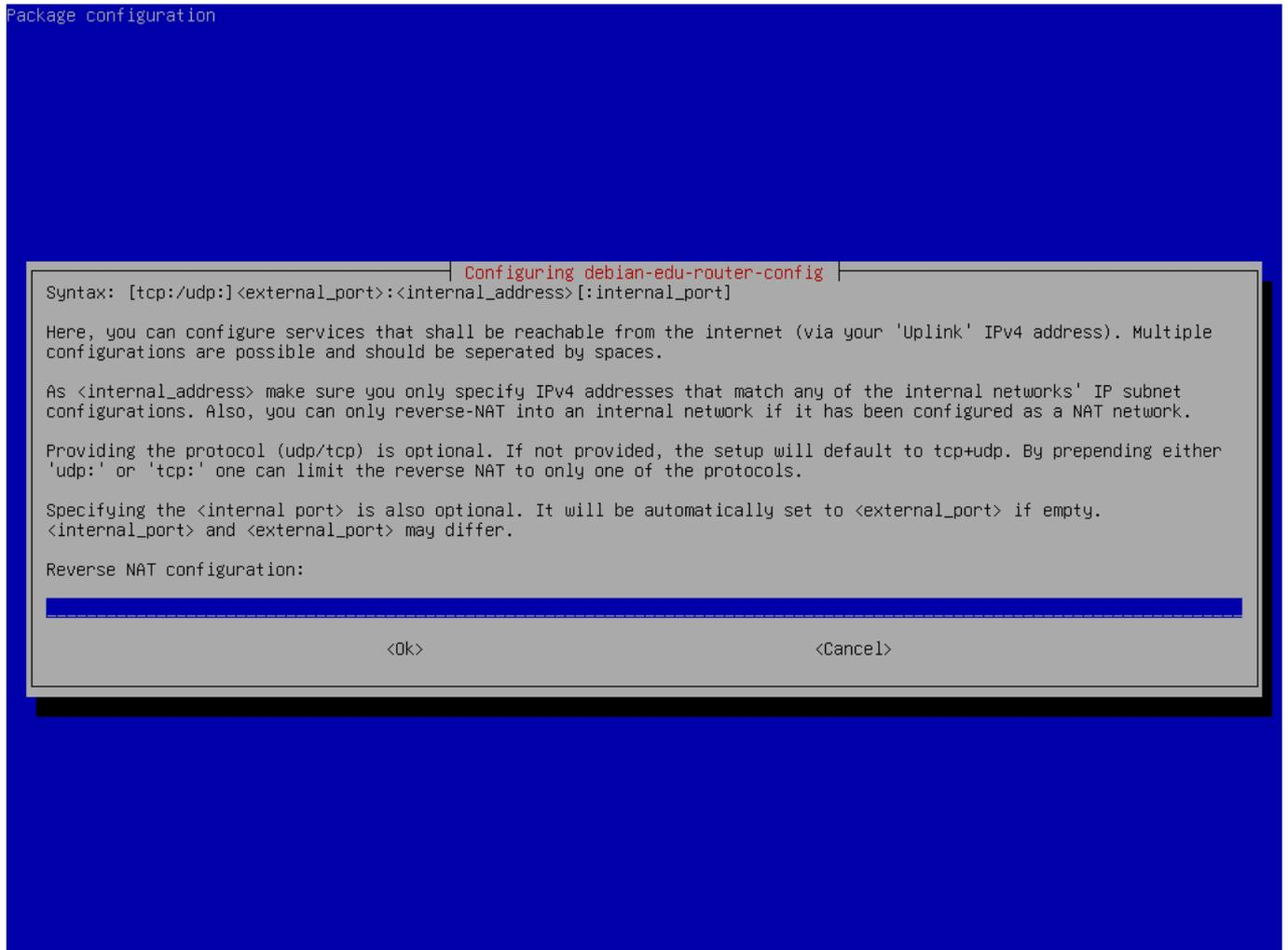
Se for pretendido expor quaisquer serviços internos à Internet, estes podem ser configurados usando a sintaxe descrita. Notar que o acesso SSH ao conversor pode ser configurado usando a caixa de diálogo a seguir.
